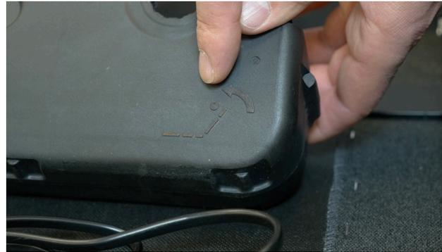
Auf dem Motor sehen Sie eine Zeichnung, daran erkennen Sie, welche Seite des Motors ans Kopfende und welches ans Fußende gehört. Der gerade Winkel bedeutet Kopfteil.
