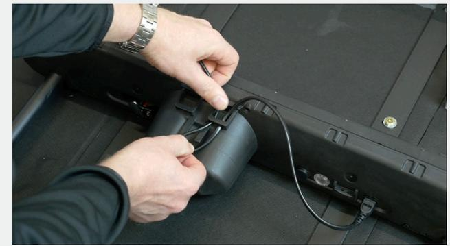
Führen Sie das Kabel in die dafür vorgesehene Sicherheitsbefestigung
